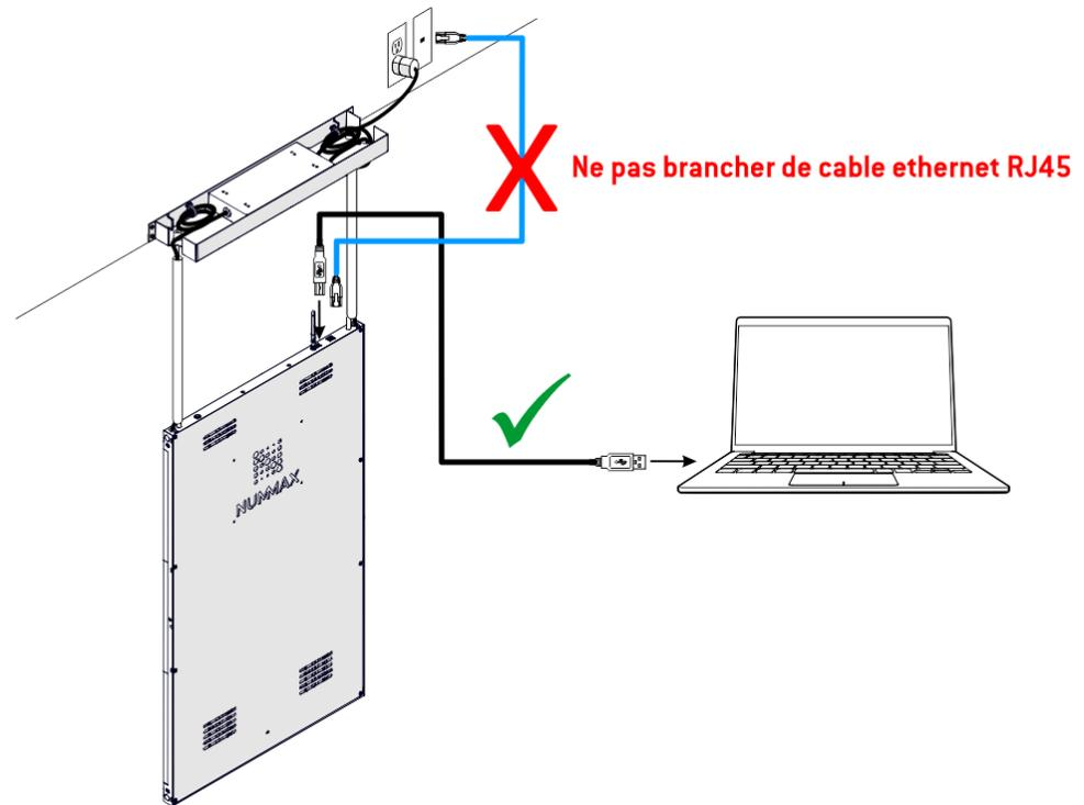
! Ne pas conserver ou brancher de cable ethernet rj45 en même temps.
