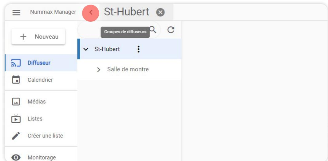
**i** Si la colonne des groupes de diffuseurs disparaît, cliquez sur l'icône de flèche en haut pour revenir à la source des groupes et cliquez sur DIFFUSEUR dans le menu à gauche. Ajustez la largeur de la colonne si besoin.
